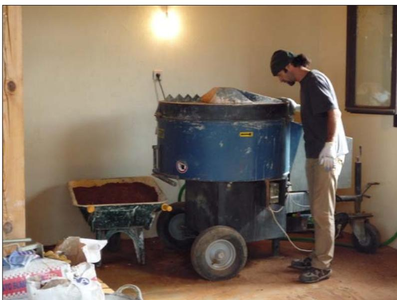
Fig. 2.- Vista de la fase de mezclado en taller: Mezcladora planetaria
