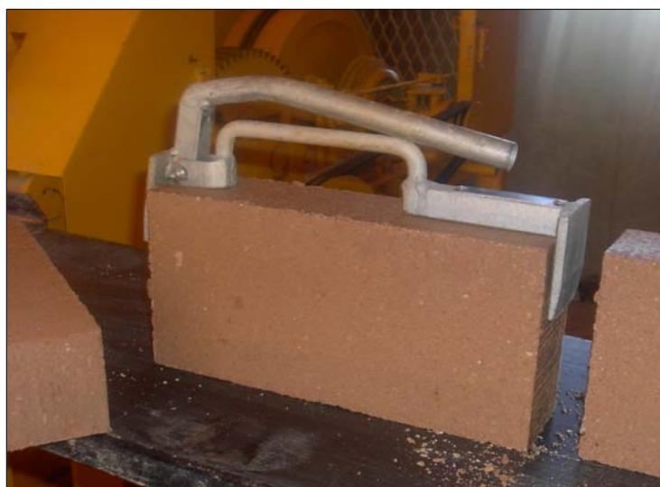
Fig. 5.- Pinzas de agarre de bloques
