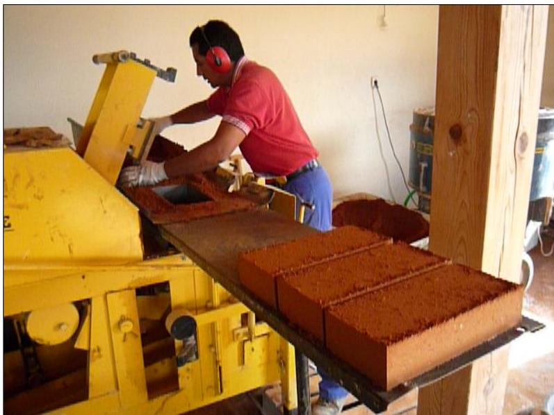
Fig. 3.- Vista de la fase de prensado: Prensa mecánica semiautomática
