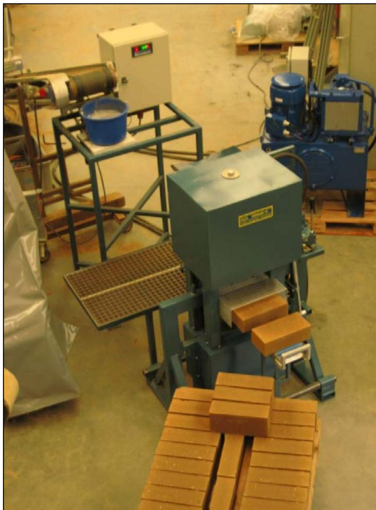
Fig. 4.- Unidad de producción adaptada: Cinta transportadora, unidad de pesado y prensa hidráulica
